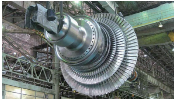
Turbine Rotor for Actual Loading Test
