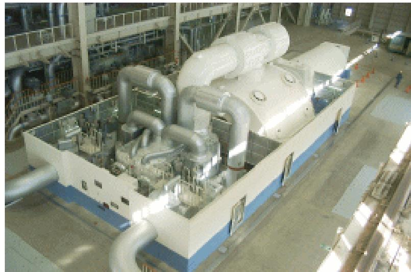
【世界最新鋭2車室型600MW蒸気タービン】
