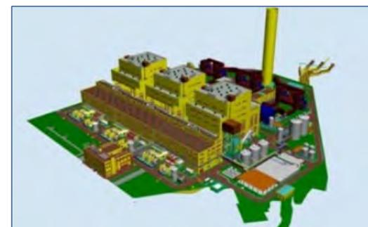
配置配管 3次元 CAD (ガスタービンコンバインドプラント)
