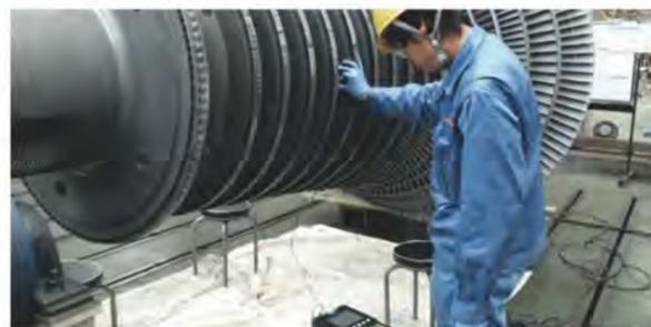
重大トラブルによるタービンの長期停止を未然に防止する為、非破壊検査を活用して、内部異常の有無の早期発見が可能な精密点検を提案します。お客様のニーズに合わせた点検項目(技術)を立案します。
