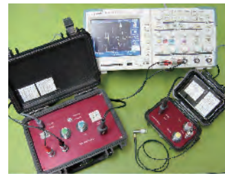
内面スケール厚さ測定 Thickness Measurement of inner scale
