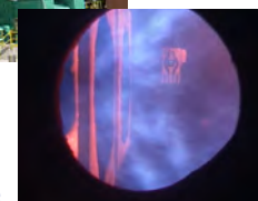
BFG燃焼火炎 BFG burning flame
