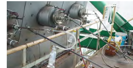
火力発電プラントにおける排ガス測定状況 Exhaust gas measurement in thermal power generation plant
