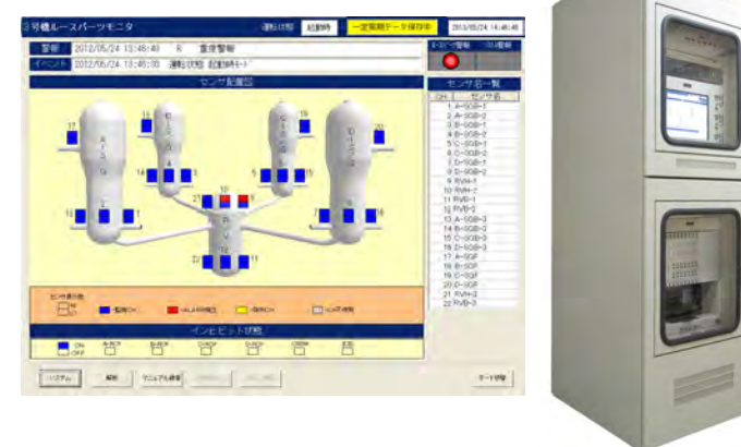
原子炉内監視診断システム（ルースパーツモニタリングシステム） Reactor diagnostic system (Loose parts monitoring system)
