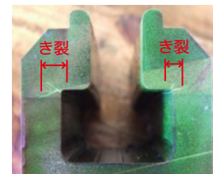
応力腐食割れ（翼溝部）
