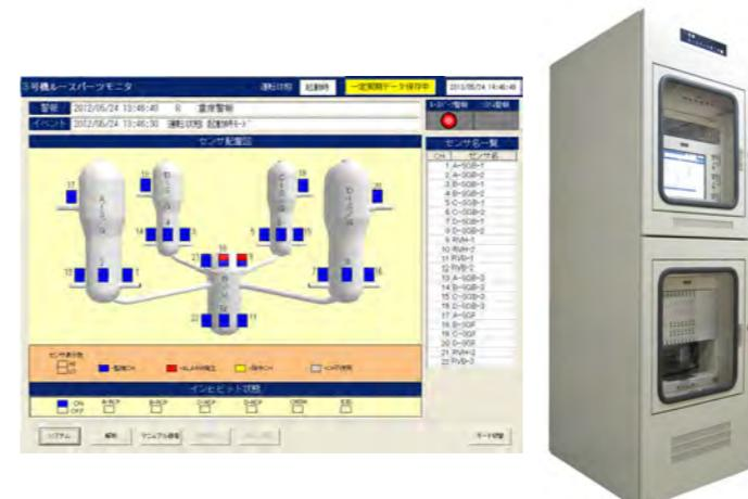
原子炉内監視診断システム（ルースパーティモニタリングシステム）
