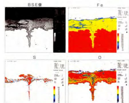
ボイラチューブ腐食疲労断面の面分析
