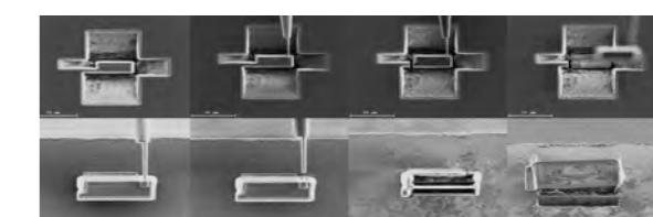
TEM分析用薄膜試料の加工例
