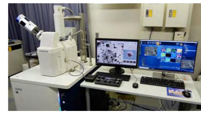
エネルギー分散形X線分析装置付走査電子顕微鏡
