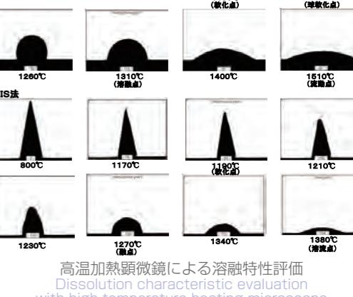
高温加熱顕微鏡による溶融特性評価
