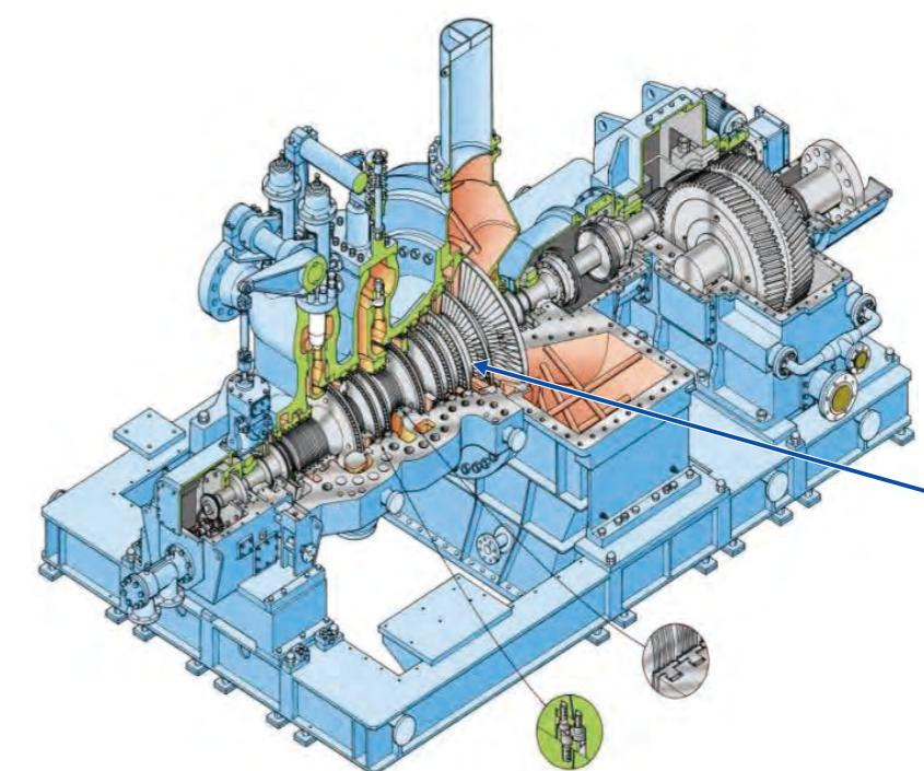
蒸気タービンロータ翼溝点検
