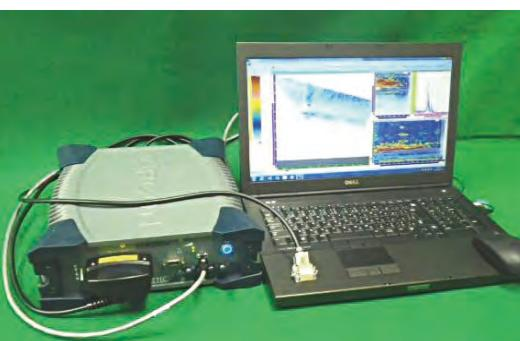
溶接部の精密診断装置
