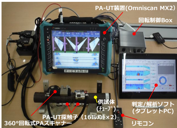
写真1. オービタル溶接部用PA-UT装置
