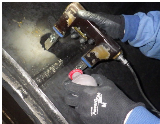
極間法（ヨーク法）の例（乾式磁粉）
