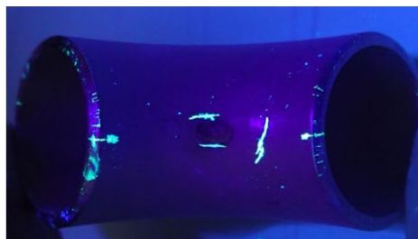
蛍光浸透探傷試験 (FPT : Fluorescent-PT)
