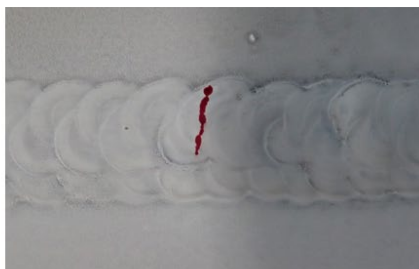
染色浸透探傷試験 (PT)
