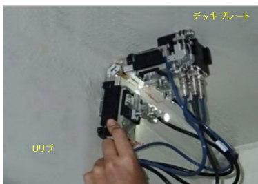
道路橋鋼床版Uリブ溶接部へのフェーズドアレイUTの適用事例
