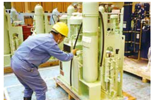
油圧ユニットの製品検査
