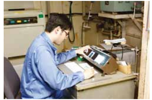
X線透過写真の判定作業
