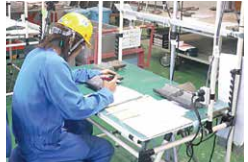
ガスタービン動翼目視
