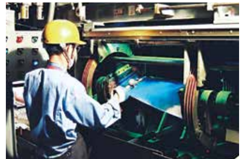
蒸気タービン動翼蛍光 MT
