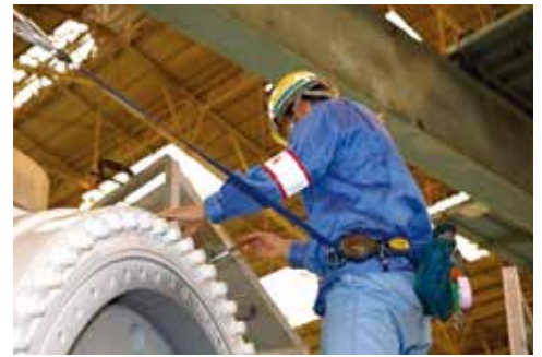
風車ローターヘッドの外観検査
