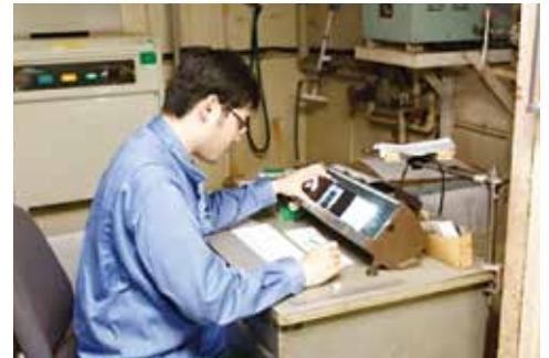
X線透過写真の判定作業
