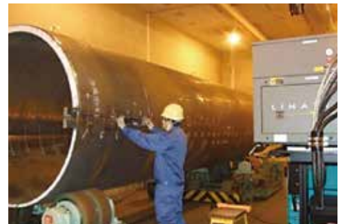
ライナックによるドラムの放射線透過検査
