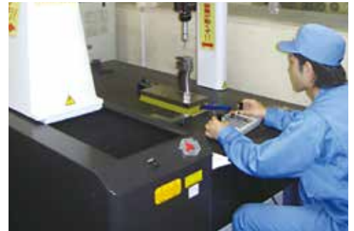
タービンブレード三次元精密計測
