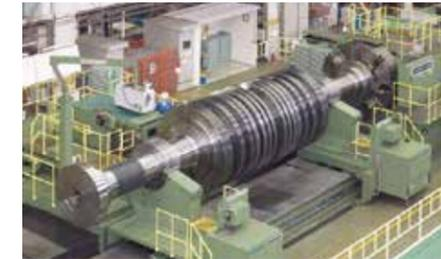
大型タービンローターNC旋盤
