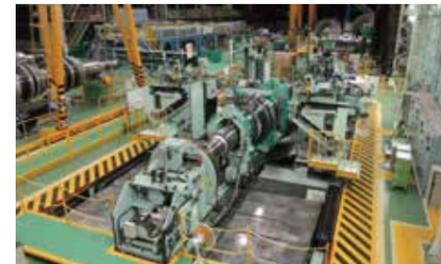
タービンローターサイドエントリー翼溝加工機
