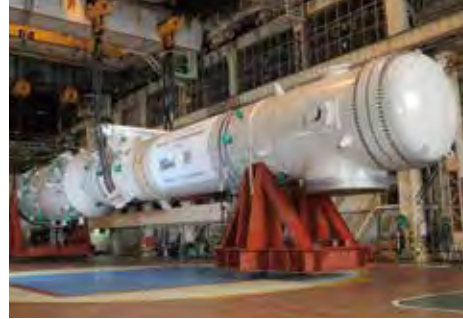
石炭ガス化複合発電 ガス化炉
