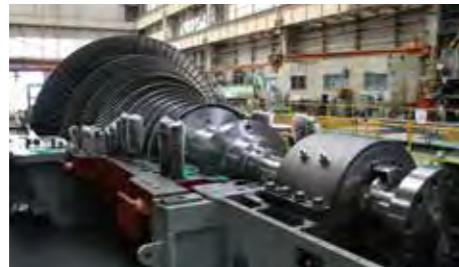
蒸気タービン
