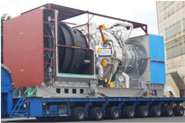
図 12 IGCC 実証試験設備(OCG プロジェクト)納め H-100 ガスタービン
