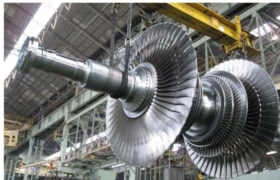
図 11 スチール製 50IN 実機ロータ例
