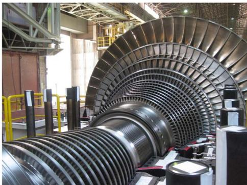
図 10 スチール製 50IN 実機ロータ例
