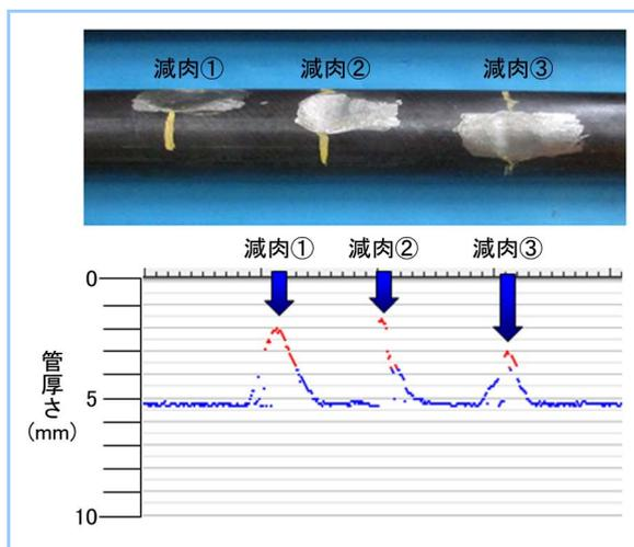
図4 肉厚計測結果(チャート図)
