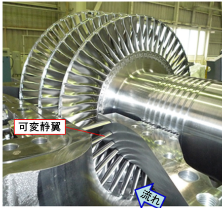
図2 動力回収タービン
