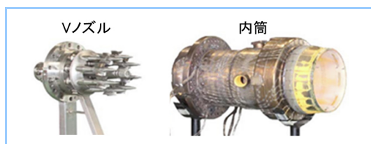
図2 Vノズルとガスタービン内筒
