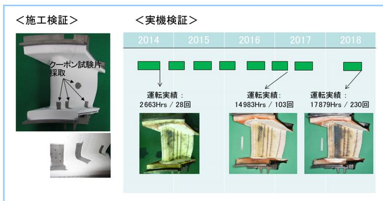
図 10 タービン1段静翼 超厚膜 TBC の検証状況
