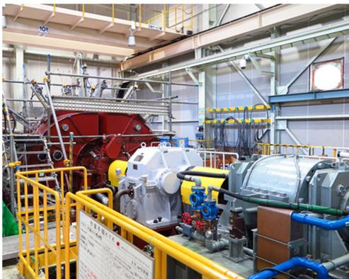
図4 蒸気タービン実証試験設備
