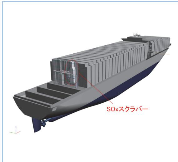
図6 大型コンテナ船にスクラバーを搭載した配置
