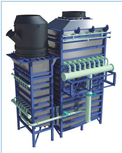
図5 船用 SOx スクラバー外観図
