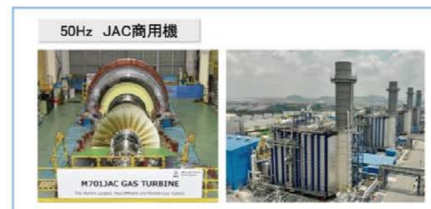
図14 M701JAC形ガスタービン商用機 運転開始(50Hz)
