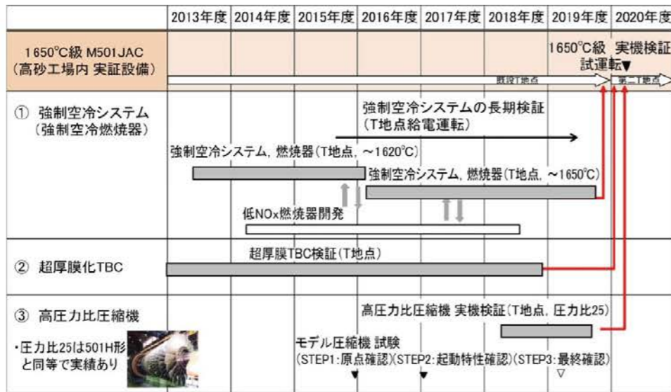
図3 要素技術の 1650°C級 JAC 形ガスタービンへの適用の流れ
